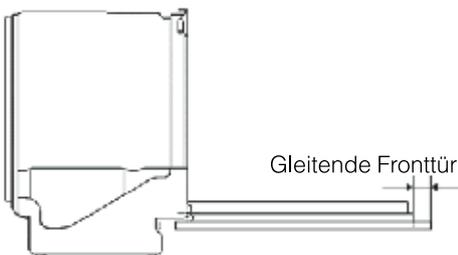
\*\* Spezifische Installation: Zum Einbau eines vollintegrierten ASKO-Geschirrspülers von 86 cm wird bei einigen Nischen- und Sockelhöhen die Verwendung eines Füllers zwischen Bedienfeld und Arbeitsplatte erforderlich (siehe Abbildung unten). In den schwarzen Zellen finden Sie die Höhe der für diese Einbaumethode geeigneten Front an.
